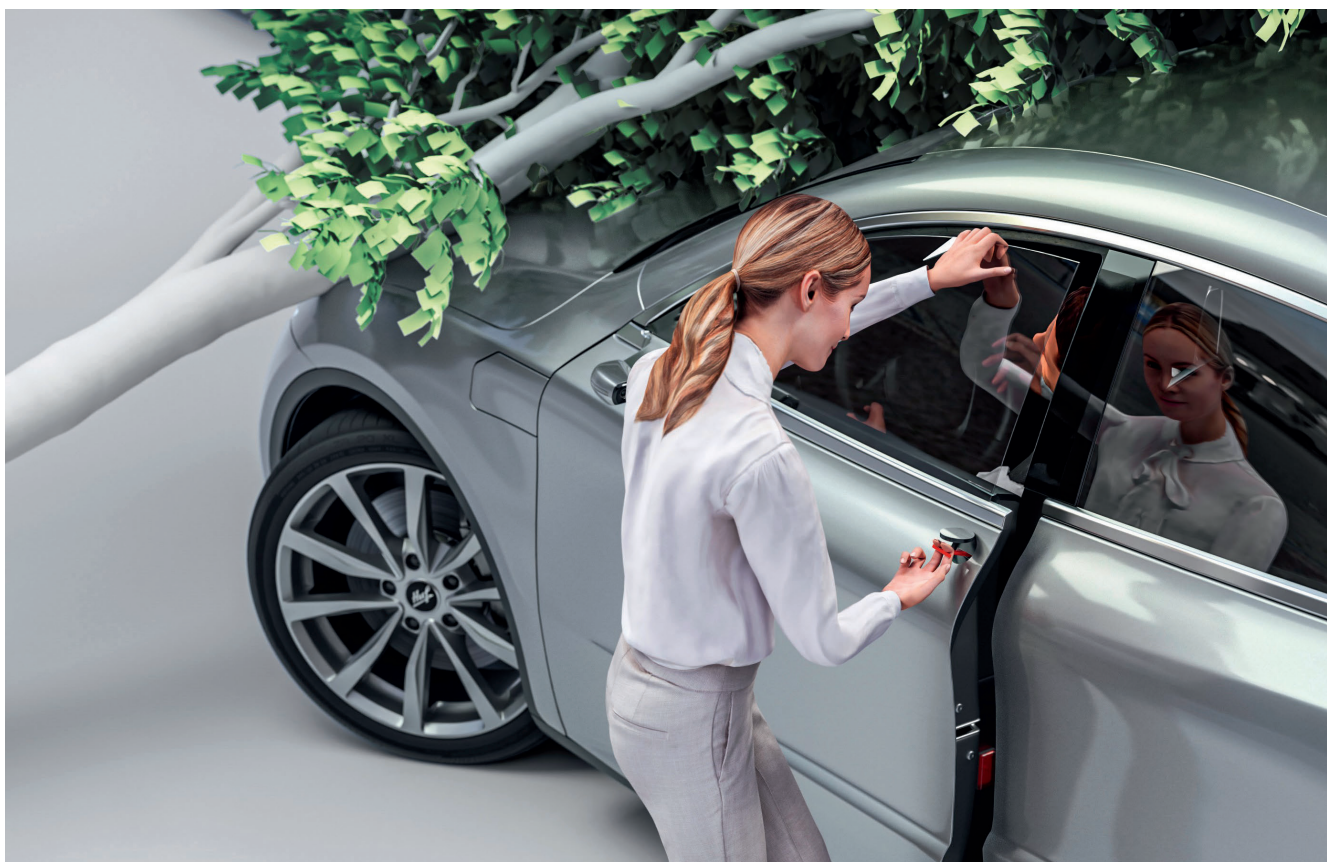
Smart Emergency Access: Bei einem Fahrzeug-Crash gibt eine Klappe den Zugriff zu einem Bowden-Zug frei. Wo genau die Klappe für die Notöffnung am Fahrzeug untergebracht ist, entscheiden Automobilhersteller. © Huf
